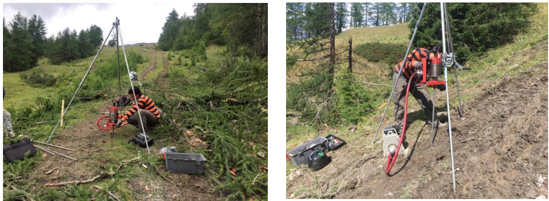
Figura 11. Esecuzione prove penetrometriche dinamiche
